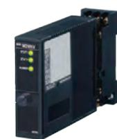
2個のアナログ信号を選択したり、1個のアナログ電圧信号を2方向に切換えたりできます。
