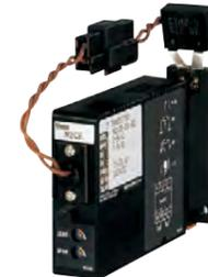
交流電流信号を計装標準信号に変換します。小形ソケットではモータの突入電流などで熔着の危険性があるため入力信号はソケットバイパスする構造になっています。
