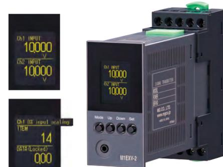
視認性の高い有機ELディスプレイを採用したM1Eシリーズが登場しました。入力スケール、ループテスト、警報テスト、リニアライズなどの機能を有しており、これらのパラメータは、有機ELディスプレイで確認しながら前面ボタンで設定ができます。2チャンネル形と4チャンネル形、1チャンネル形（多出力タイプ）をご用意しています。
