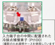
入力端子台の中間に配置された冷接点補償素子 (Pt100) (撮影のため透明ケースを使用しています)
