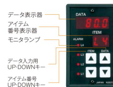
M・UNITデジアラームシリーズは設定のすべてを前面パネルから行えます。明るいLEDのため薄暗い現場パネルでも間違いなく設定できます。また安全のためソフトキーにより設定値をロックできます。
