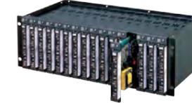
フィールド側絶縁2チャンネル変換器 15-RACK Series
