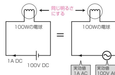
直流 100V DC 電源に 100W の電球を接続すると 1A の電流が流れる。この電球の明るさが同じになるように交流電圧を調整すると交流電圧は 100V となる。この交流電圧値 100V AC のことを実効値という。そのときに流れている電流値が実効値 1A AC である。
