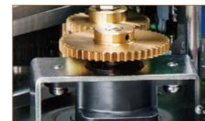
産業車両や建設機器に搭載するタイプのポテンシオメータを採用し耐振動性、高品質および長寿命を実現しています。
