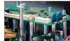
発熱するモータ制御基板と電子回路を分離し、さらにモータ制御基板の放熱効率を上げることで発熱対策を図っています。
