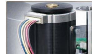
駆動部に非接触構造で長寿命のステッピングモータを採用しました。1パルスあたり1.8°でモータの回転角度を制御できるため、高い精度で開度制御が行えます。
