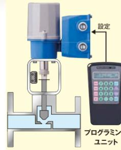
ミニトップをバルブに組付け、プログラミングユニット (形式：PU-2A) でストローク指定と下降側シールスプリング押込量を入力します。
